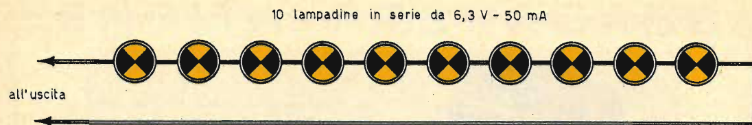
Fig. 4 - Su tutte e tre le uscite, corrispondenti ai tre canali amplificatori, si applicheranno dieci lampadine, collegate in serie tra di loro, da 6,3 volt-50 mA.
