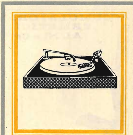
Fig. 4 - Un altro sistema per mantenere costantemente pulito il disco consiste nell'applicare sul disco stesso un bilanciere munito di spazzolina e un piccolo rullo di peli flessibili atto a raccogliere la polvere.
