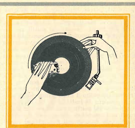
Fig. 3 - Il sistema più comune per raggiungere una buona pulizia delle superfici del disco consiste nel far ruotare il disco stesso sul piatto giradischi, a mano, mentre si strofina su di esso una spazzola con peli di seta antistatici.
